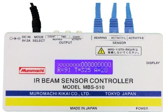
液晶ディスプレイでビームの状態をいつでも確認できます。ビームが遮られている部分は「-」、電源投入時から使用できない部分は「X」、通常時は「O」で表示します。
