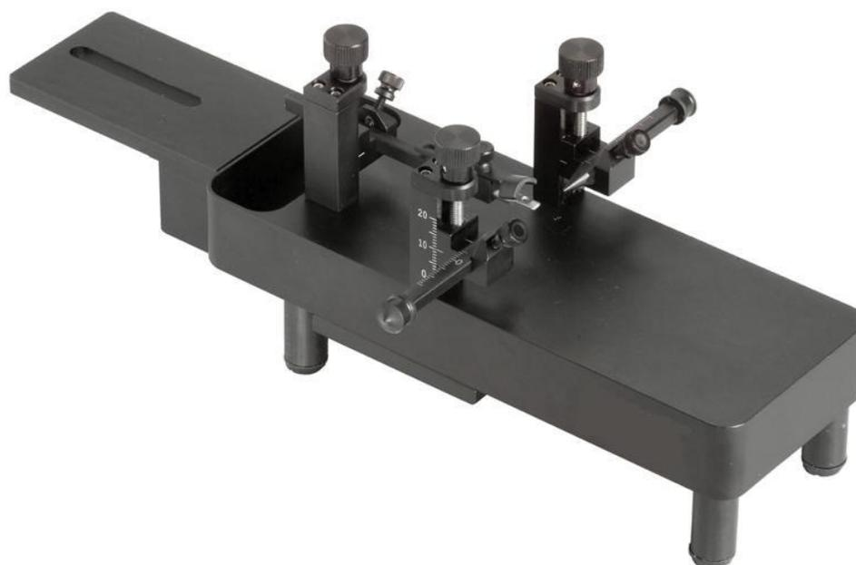
本装置は、ステレオタキシク用のネオネイタルラット及びマウス用アダプタです。既存のステレオタキシクにセットするだけで簡単に使用する事が可能です。また独立設計の為、よりマウスに適した固定が可能となっております。イアバーには、ラバーキャップの他に Jaw holder が付属しておりますので、用途に合わせた固定が可能となります。
