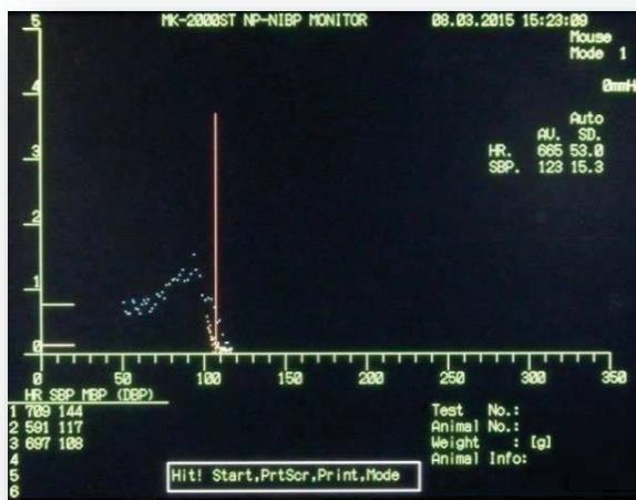
測定中、脈の波形がディスプレイにリアルタイムで表示されますので、動物の状態を把握し、**正確に測定**が出来ているか確認することが可能です。
