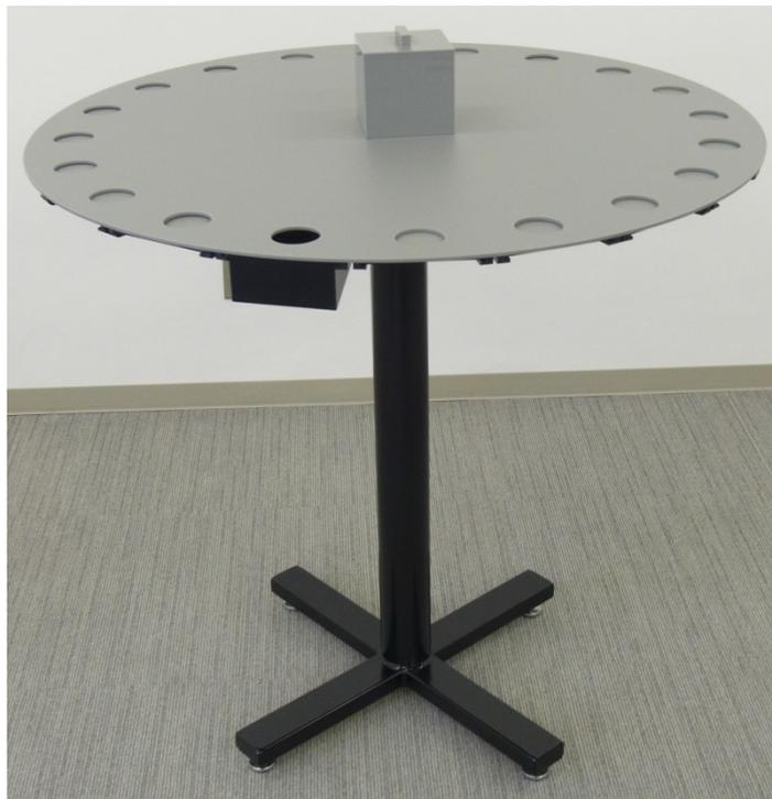
バーンズ迷路は記憶学習実験に用いる装置です。円盤の周囲に等間隔で穴が20個開いており、内1箇所には円盤裏側に逃避用のエスケープ・トンネルがセットされています。明るく、ツルツルな表面を嫌うマウスは穴を覗いているうちにエスケープ・トンネルがセットされた穴にたどり着きます。2回目以降は空間認知により、エスケープ・トンネルにたどり着くまでの時間が短縮されます。
