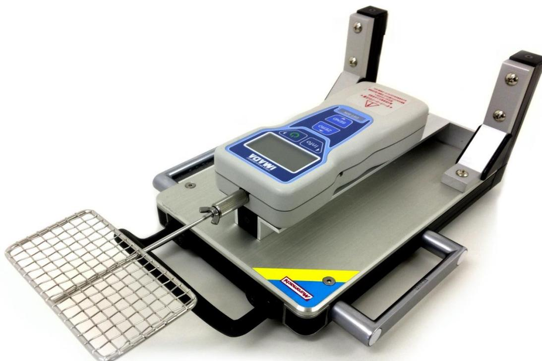
本装置は、動物の前肢の握力を測定する装置です。動物を測定バーに掴ませ引っ張ることで、簡単に動物の最大握力を測定することができます。測定には高精度のトランスジューサを使っており、精度の高い数値を表示します。また、RS232C 出力ポートが標準装備されており、得られたデータを PC に転送することができます。
