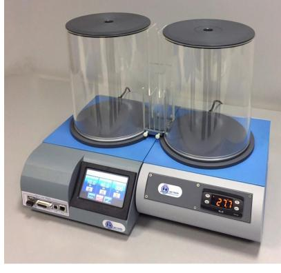
マウス用 ラット用 加熱または冷却、両方の 刺激下での、 疼痛閾値 モニタリング
