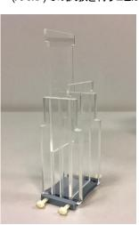
マウス35250-003用のセットは、 W45xH95mmの開口部を持つ2本 の特殊なケージで構成されており、 その間は4cmに最小化された金 属製ブリッジで接続されています。
