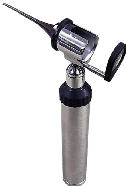
本製品は、ラットまたはマウスへの気管挿管作業を補助する器具です。
